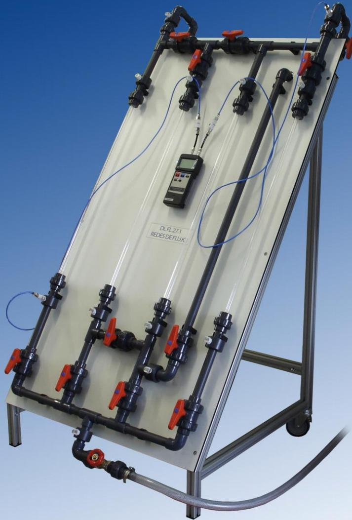
El equipo "Redes de flujo" refleja a escala el problema que habitualmente aparece para el cálculo de presiones y caudales en tuberías que se interconectan entre sí. Estas tuberías habitualmente son de diferentes diámetros y longitudes y forman entre sí diversos sistemas (en serie, en paralelo, red mallada...) lo que complica severamente el cálculo.
